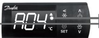
Les codes de température et d'alerte clignotent alternativement jusqu'à ce que la cause d'alerte soit supprimée. La cloche d'alerte est affichée.
