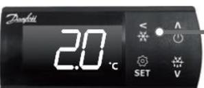
REFROIDISSEMENT RAPIDE: Appuyer durant trois secondes pour déclencher un refroidissement rapide.
