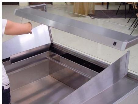
Basculer légèrement la protection anti-éclaboussures à droite + à gauche vers l'extérieur et la retirer par le haut.
