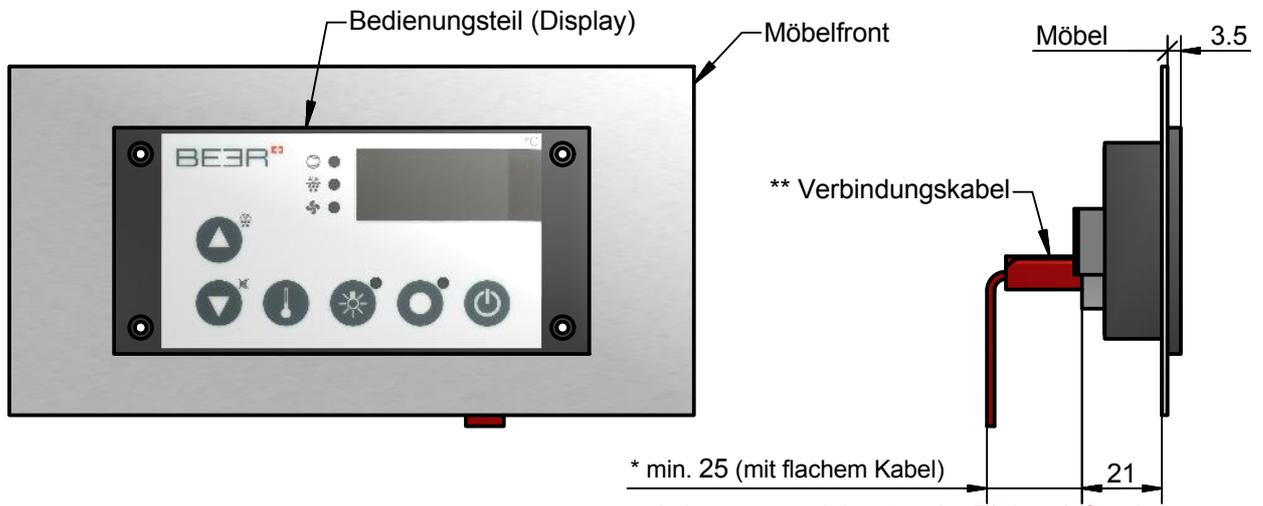
\* min. 25 (mit flachem Kabel)
