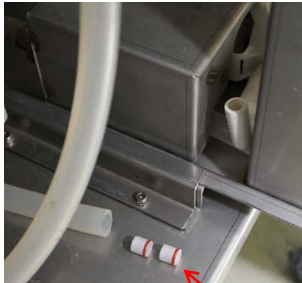
Rückflussverhinderer Art. 3902208 Achtung: Flussrichtung beachten
