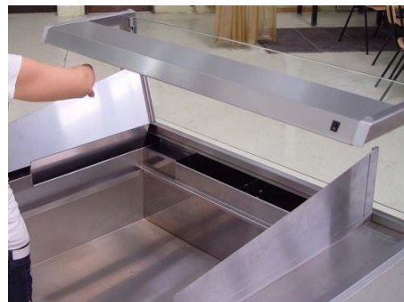
Spritzschutz rechts + links leicht nach aussen kippen und nach oben herausziehen.
